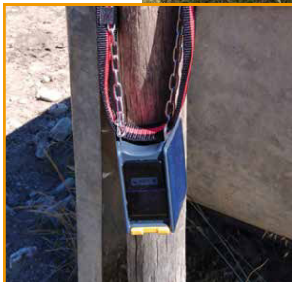
Uno dei tecnici di Vistock al lavoro nei pascoli del Mugello Sotto: particolare di uno dei collari usati nella sperimentazione. Si nota il pannello solare sulla destra che fornisce energia al sistema
